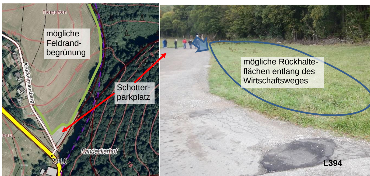
Abbildung 10 mögliche Rückhalteflächen Bereich Randeckerhof
