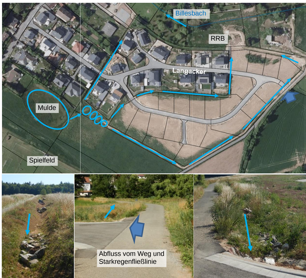
Abbildung 34 Außengebietswasserableitung Neubaugebiet Schlossbergblick
