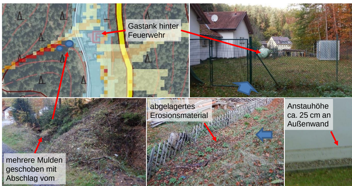
Abbildung 10 Überflutungsgefährdung Feuerwehr / Schäden Ereignis 2006
