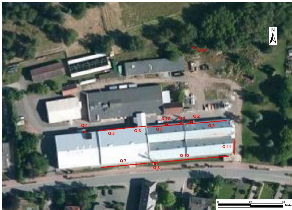
Abb.1: Quellenplan: Q1: HWO2; Q2: HWO3-4; Q3: BK1-3, Trockenkammer 1+2, TNV-Aushärteöfen / Brennöfen EO A bis F; Q4: Mischerabluft; Q5-Q11: Raumluft, Q12: HWO1, Q13: HWO-Erweiterung
