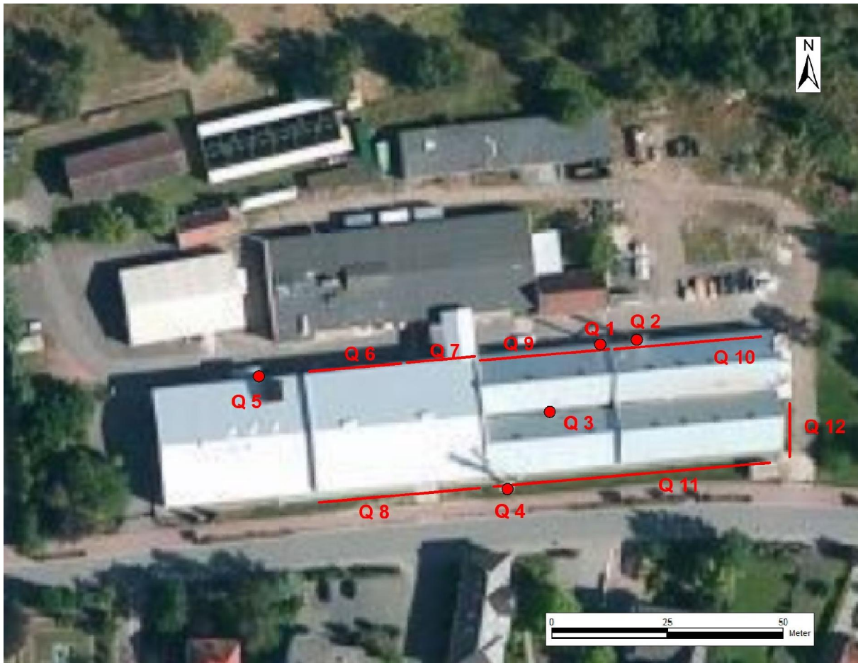
Abb. 5.1: Quellenplan: Q1: HWO2, Q2: HWO3-4, Q3: BK1-3, Q4: Trockenkammer / Tunnelofen, Q5: Mischerabluft, Q6-Q12: Raumluft
