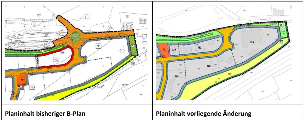
Abbildung 4: Änderungen Rückhaltefläche und Trafostation
