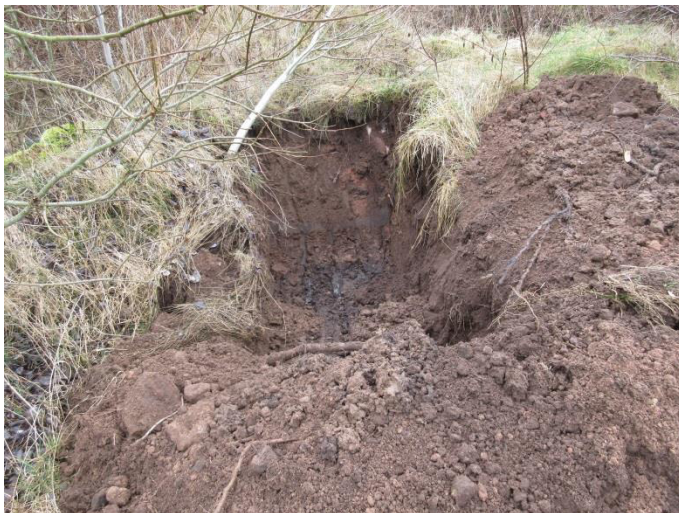
Schurf Haufwerk 2 An der Sohle: Schwarzdecke
